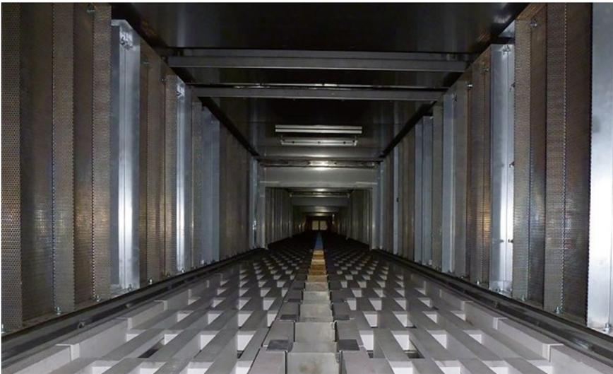
**Bild 3** Der Schubplattenofen eignet sich für die Massenproduktion von SOFC-/SOE-Produkten aufgrund seiner hohen Durchsätze mit geringen Energieverlusten besonders gut. (© Onejoon)
